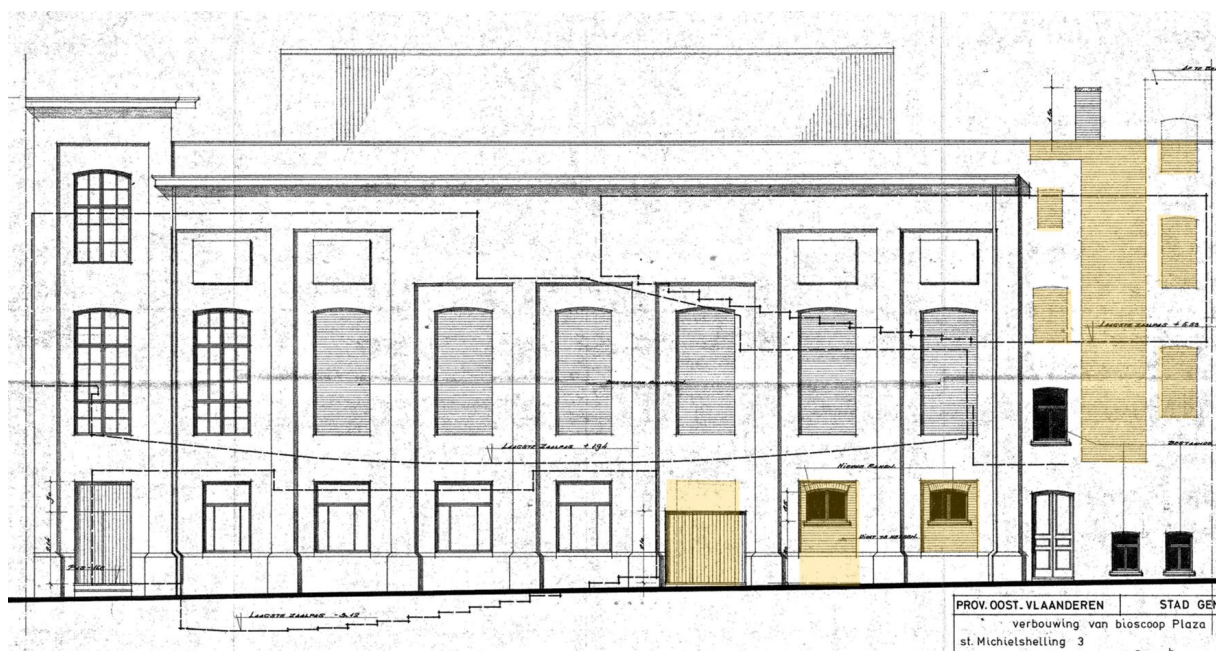
Fig. 27 : 1977, nieuwe toestand van de gevel aan Jan Van Stopenberghestraat, met aanduiding van de veranderingen die werden uitgevoerd (Gent, SA & Mar Jaen)
