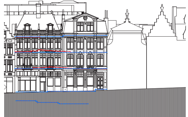
Schematische projectie van de nieuwe vloervelden (blauw) ten opzichte van de bestaande (rood) op de gevel Sint-Michielshelling.
