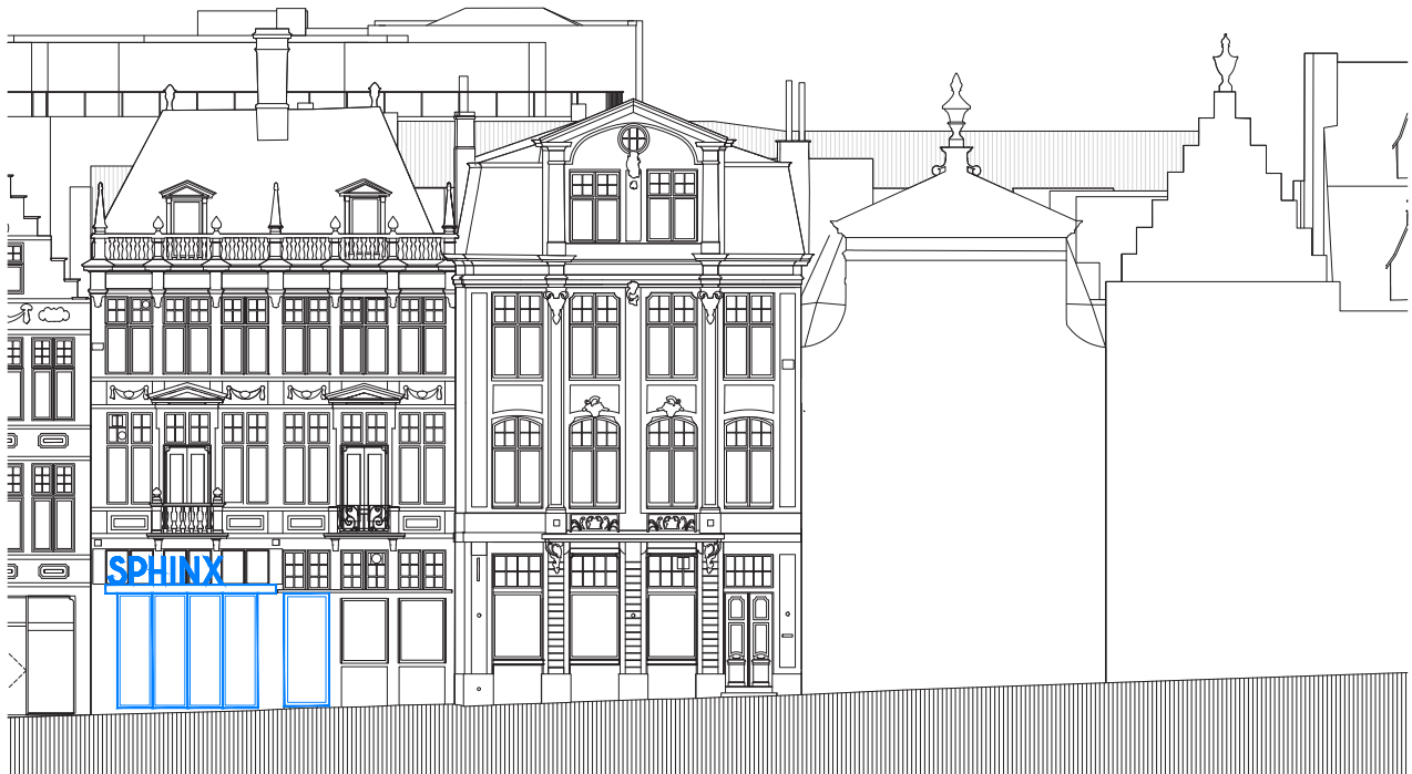
Nieuwe situatie: gevel Sint-Michielshelling met aanduiding nieuwe inkom, luifel en signalisatie. (Aandacht: dit is geen ontwerp, louter een schematische voorstelling van het voorkeursmodel in de haalbaarheidsstudie)
